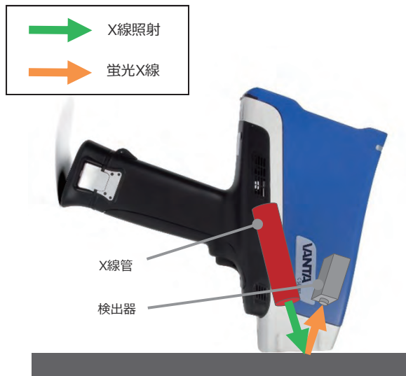
分析時のX線照射・蛍光X線検出イメージ
